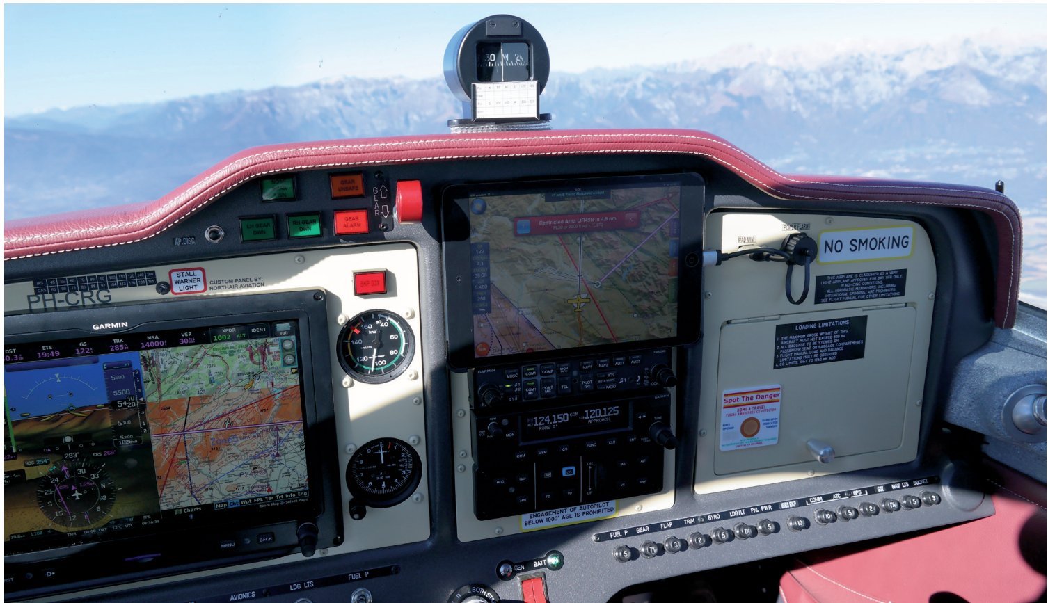
Garmin G3X Touch, Powerflarm Core, autopilot, iPad Mini 3 met Garmin Pilot, Skydemon navigatiesoftware...
