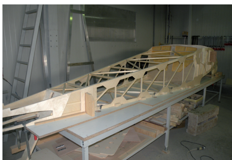
Het houten airframe is 'bedekt' met een koolstofvezel omhulsel.
